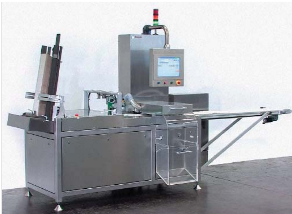
CPS0300. Технология отслеживания и контроля использует модуль системы печати на картонных заготовках (CPS), который автоматически печатает код и наносит его на каждый продукт
