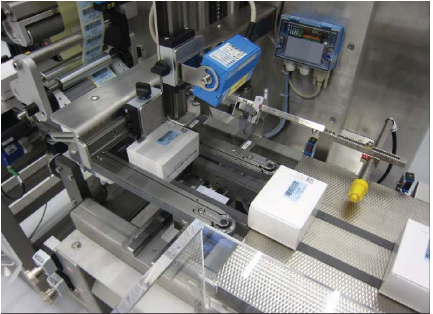
CPS1600L2. Новая система позволяет одновременно наносить уникальный серийный номер, номер партии, глобальный номер товара (GTIN), а также срок годности
