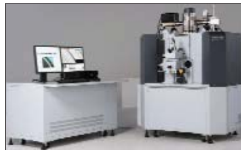
Фото № 2. Электронно-зондовый микроанализатор SHIMADZU модели EPMA-1720
