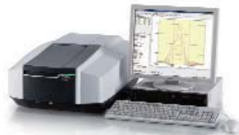
Фото № 1. Спектрофотометр УФ-видимого диапазона SHIMADZU модели UV-2700
