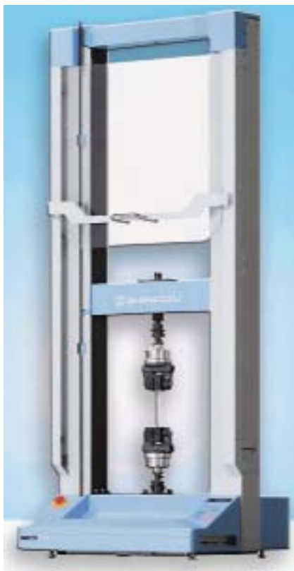
Фото № 7. Испытательная машина SHIMADZU модели AGS-10kNX
