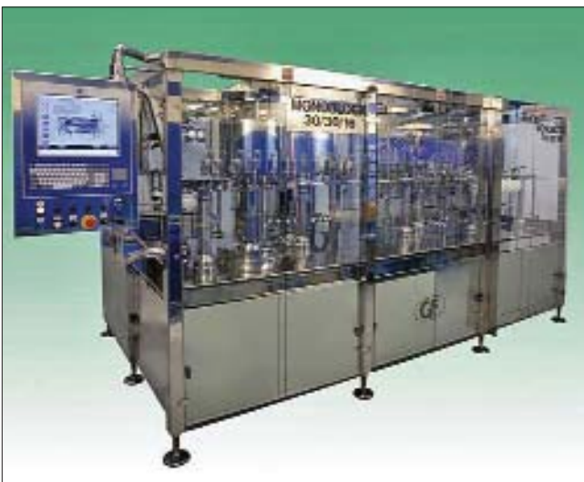
Моноблок розлива в полипропиленовые или полиэтиленовые бутылки/ пакеты
