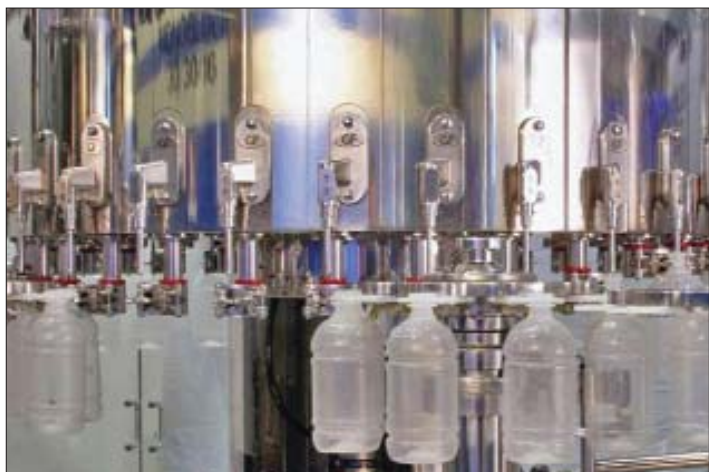
Переход на разные размеры происходит без сменных форматных деталей
