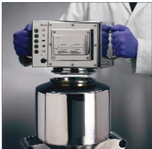
Рис. 4. Antaris Target, устанавливаемый на мешалку
