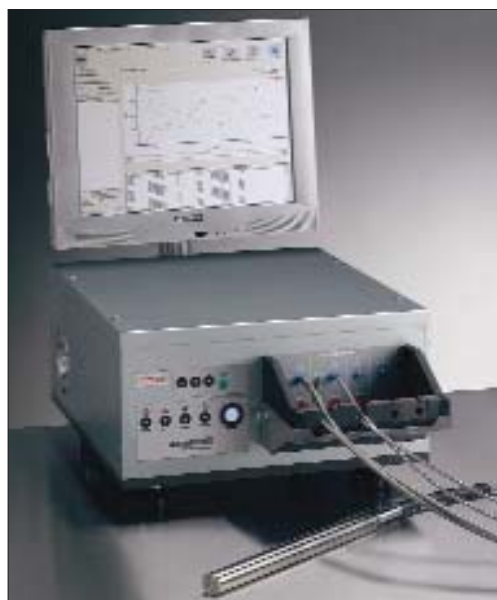
Рис. 5. Antaris MX – БИК-анализатор для технологического контроля
