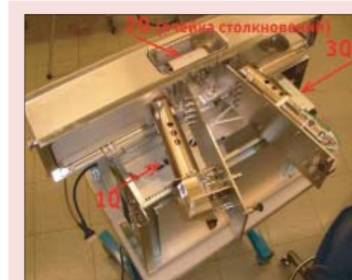
Рис. 1. Agilent QQQ 7000B масс-детектор с двумя квадрупольными анализаторами на дверцах в сервисной позиции
