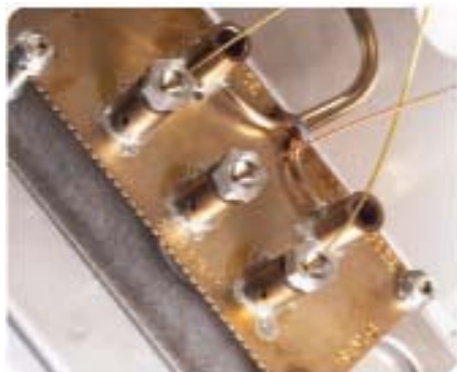
Рис. 6. Микропотоковый делитель потоков с возможностью реализации обратной продувки
