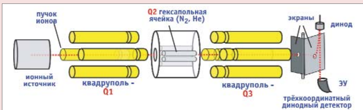
Рис. 2. Схема масс-детектора Agilent 7000B с трехквадрупольным анализатором масс
