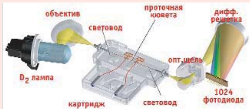
Рис. 13. Проточная кювета и оптическая схема диодно-матричного детектора Agilent 1290 Infinity (160 Гц). Программируемая ширина оптической щели (1–8 нм)
