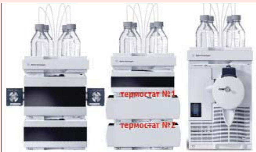
Рис. 12. Конфигурация Agilent 1290 Infinity с двухканальным насосом, двумя термостатами колонок, двумя дополнительными внешними кранами-переключателями потоков и масс-детектором Agilent 6130
