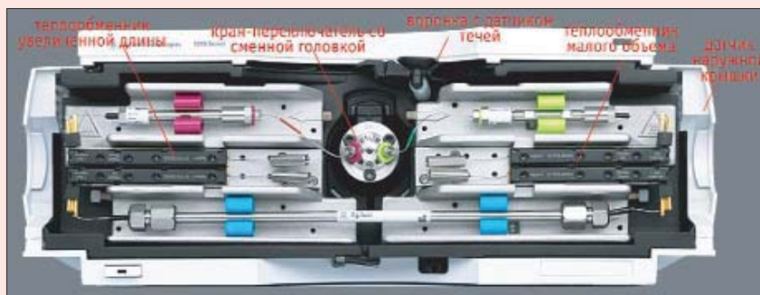
Рис. 10. Термостат колонок 1200 Infinity со снятой наружной крышкой. Отмечены некоторые из элементов, конструкция которых претерпела изменения
