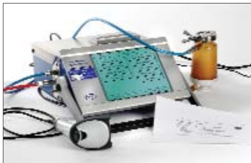
Рис. 1. Прибор Palltronic Flowstar XC с прибором считывания штрих-кодов – преимущества использования благодаря простым вспомогательным средствам ввода данных и интуитивному интерфейсу
